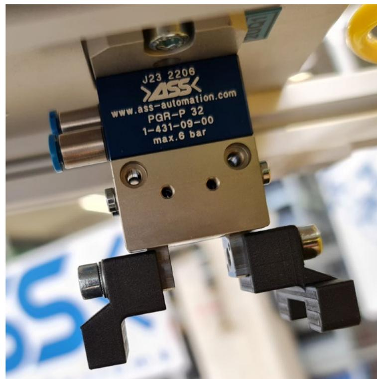
Dieser Greifer wird dann innerhalb von 3-6 Tagen an den Kunden ausgeliefert. Bisher haben Kunden den Greifer gekauft und dann selbst im Betriebsmittelbau Greiferbacken anfertigen lassen. Für den Kunden ist das eine Rundumsorglos-Lösung aus dem Haus ASS.
